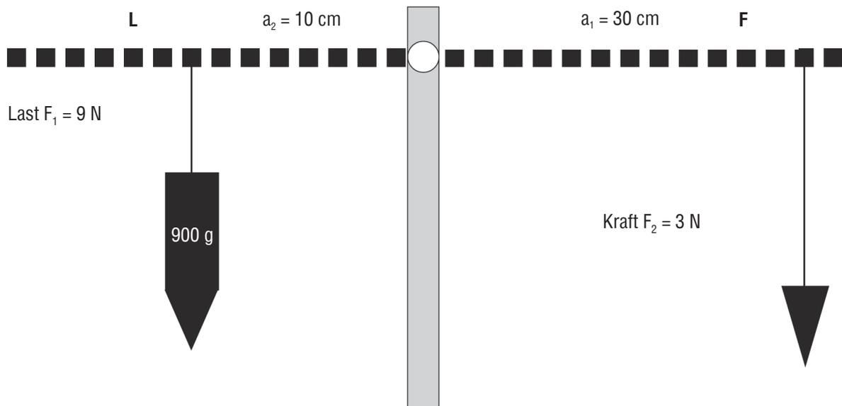
Damit der Hebel im Gleichgewicht ist, muss das Produkt aus Kraft und Länge des zugehörigen Hebelhauses auf beiden Seiten gleich sein.
